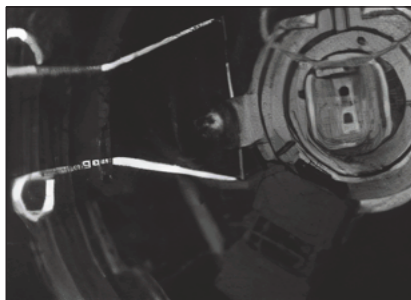
لبه بالایی پایه لامپ باید در داخل شیار سوکت قرار گیرد
