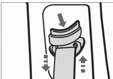
۱. برای تنظیم ارتفاع کمربند ایمنی، ضامنی که در بخش بالایی تنظیم کننده ارتفاع واقع در ستون وسط وجود دارد را فشار دهید. با این کار تنظیم کننده ارتفاع آزاد می شود و می توانید آن را به سمت بالا یا پایین حرکت دهید. با رها کردن دکمه، تنظیم کننده ارتفاع قفل می شود و در محل مورد نظر شما باقی می ماند.
