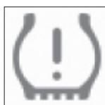
این چراغ زمانی روشن می‌شود که فشار باد تایرها بیش از اندازه بالا یا بیش از اندازه پایین باشد و یا خطایی در سیستم کنترل فشار باد تایرها رخ داده باشد.
