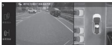
۲. بر روی کلید پارک خودکار کلیک کرده و پس از آن بر روی گزینه YES در صفحه نمایش کلیک کنید. پس از آن گزینه Automatic parking انتخاب کرده و بر روی صفحه نمایش، جهت خروج از پارک را با استفاده از حرکت انگشت بر روی صفحه نمایش انتخاب کنید.
