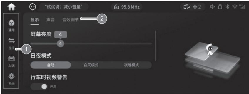
۱. در این بخش می‌توانید تنظیمات عمومی، تنظیمات مربوط به اتصال، تنظیمات خودرو و تنظیمات سیستم را ببینید. با کلیک بر روی هر بخش، وارد تنظیمات اختصاصی آن خواهید شد.
