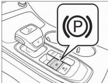
\* برای شروع حرکت چه مسیرهای شیبدار و چه در مسیرهای مسطح، کافی است راننده پای خود را بر روی پدال گاز فشار دهد تا اتوهلهد به صورت خودکار آزاد شده و خودرو شروع به حرکت کند. در این شرایط اتوهلهد همچنان فعال است و در توقف بعدی، بار دیگر به صورت خودکار وارد مدار خواهد شد.
