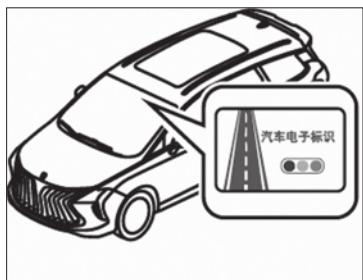
این بخش در بالای شیشه جلوی و در مرکز آن قرار دارد و اطلاعات خودرو در آن درج شده است که با تجهیزات ویژه‌ای قابل خواندن است. این بخش با آینه وسط، سنسورها، دوربین و ... پوشیده و مخفی نمی‌شود. این بخش بسته به قوانین داخلی کشورهای مختلف، ممکن است بر روی خودرو نصب شده یا خودرو فاقد آن باشد.
