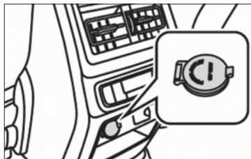
خروجی برق ۱۲ ولت عقب در انتهای کنسول میانی و زیر خروجی‌های سیستم تهویه عقب قرار دارد.
