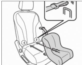
۲. بر روی صندلی‌های کودکی که بر اساس این استاندارد تولید شده باشند، اتصالات ISOFIX در راستای اتصالات نصب شده روی صندلی خودرو وجود دارد. اتصالات سخت را باید در محل خود جا بزنید و اتصالات نرم را مانند سگ درگیر کنید.
