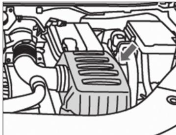
این خودرو به باتری sealed مجهر است و نیازی به افزودن مایع (آب باتری و یا اسید باتری) به آن نیست. این باتری که در سمت راست موتور نصب شده است، نیروی لازم برای آغاز به کار موتور را فراهم کرده و در زمان خاموش بودن موتور، برق مورد نیاز برای راهنمایی تجهیزات دیگر را تامین می‌کند. در صورتیکه توان باتری کاهش پیدا کند، ممکن است برخی تجهیزات الکتریکی خودرو به درستی کار نکند و یا خودرو نتواند به خوبی استارت بزند.
