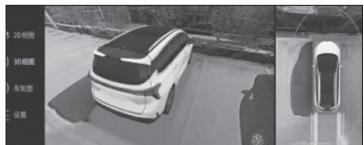
در بخش چپ صفحه نمایش، بر روی گزینه 3D View کلیک کنید تا تصویر سه‌بعدی درجه از خودرو را ببینید. با قرار دادن انگشت بر روی تصویر و حرکت دادن آن، می‌توانید خودرو را از زوایای مختلف ببینید. در این نما، امکان زوم کردن بر روی تصویر نیز وجود دارد.
