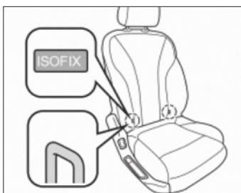
۱. اتصالات ISOFIX بر روی صندلی وسط و در بخش اتصال کفی و پشتی صندلی نصب شده است.
