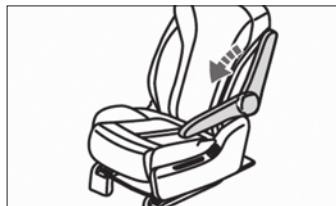
در مدل‌هایی که ردیف دوم آن‌ها دارای دو صندلی جداگانه است، دسته صندلی نصب شده است. برای استفاده از دسته صندلی، آن را به سمت پایین بکشدید. برای جمع کردن دسته صندلی کافی است آن را به سمت بالا حرکت دهید.
