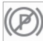
این چراغ زمانی روشن می‌شود که سیستم ترمز پارک برقی خودکار دچار مشکل شده باشد. در این شرایط خودرو همچنان توانایی پارک کردن دارد ولی نمی‌تواند به صورت خودکار ترمز پارک برقی را فعال کند. در صورت روشن شدن این چراغ، در زمان توقف، کلید ترمز پارک برقی را به صورت دستی فعال کنید و با مراکز خدمات پس از فروش فردا تماس بگیرید.
