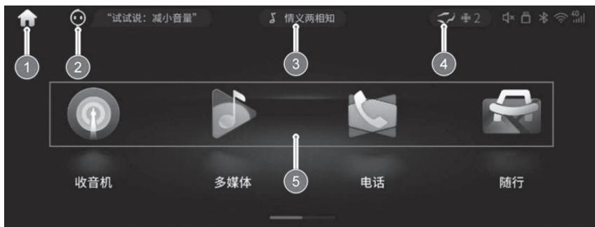
۱. کلید خانه: با کلیک کردن بر روی این کلید در هر بخشی از سیستم، به صفحه اصلی باز میگردد.
